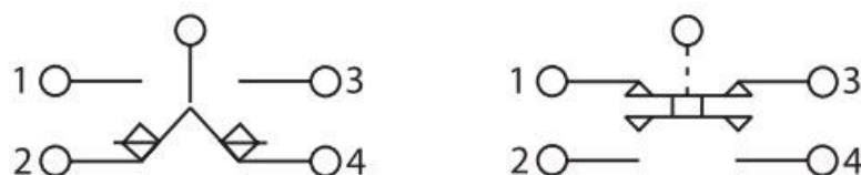
Рисунок 1. Принципиальные электрические схемы путевых выключателей полумгновенного и прямого действия.
